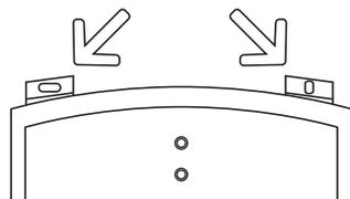
2. Fija la central a la pared utilizando los taquetes de 1/4 de pulgada y las pijas del #10 x 1 1/4.
