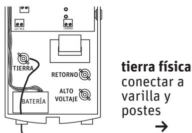
4. Conecta el cable de tierra a la terminal «TIERRA FISICA». Este cable debe estar conectado a los postes y a la varilla.
