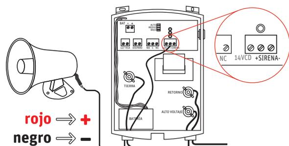
9. Conecta la sirena. Debe colocarse a 14m máximo de la central, alejado de caídas de agua o humedad. Conecta a la central con el cable dúplex, el cable rojo se conecta a «SIRENA +» y el cable negro a «SIRENA -».
