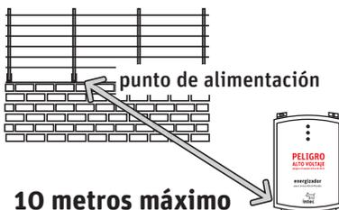
1. La central debe quedar a 10m máximo de distancia del punto de alimentación del tendido de alto voltaje.
