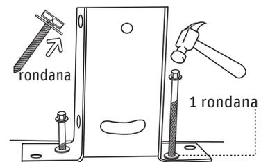
3. En las perforaciones interiores introduce una rondana al tornillo y fíjalo.
