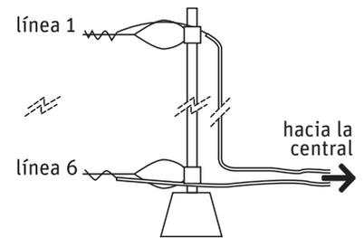
14. Asegúrate de realizar un amarre seguro entre el alambre y el cable doble aislado.
