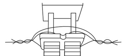
11. El puente en los amarres laterales puede quedar sobre el aislador o de frente, asegúrate que no quede cerca del poste.
