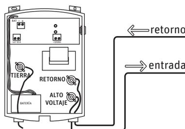
5. El cable doble aislado se conecta en 2 terminales o mariposas: el «ALTO VOLTAJE» al punto de entrada en el alambrado y: «RETORNO» al segundo punto de alimentación.
