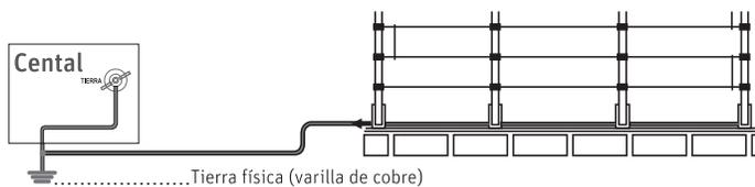
4. En la central se debe conectar el cable para tierra a las bases y a la varilla, en la terminal TIERRA.
