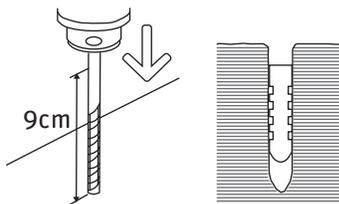
2. Barrena 9 cm de profundidad con la broca incluida. Introduce el taquete en las 4 perforaciones.
