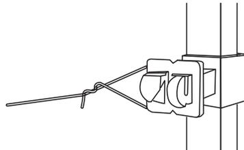
2. Amarra el alambre dando 2 vueltas, esto permite mantener la tensión del conductor más no el peso de una persona (fusible de tensión mecánica).
