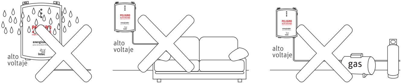
1.- La central de alto voltaje debe colocarse al interior, lejos de caídas de agua, cerca de una toma de corriente y a una distancia menor a 10 metros del punto de alimentación de la cerca. No la instales en recámaras, comedor o sala ni cercano a fuentes de calor, ni tanques de gas.
