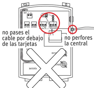
7. El cable doble aislado no puede quedar por debajo de los circuitos electrónicos, pásalo por un costado.
