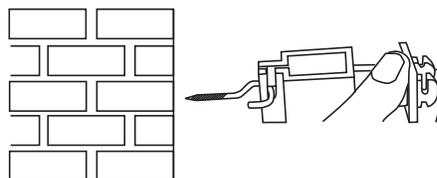
8. Si la barda remata en pared utiliza una armella para fijar los aisladores. Quita el tornillo de los aisladores y sustitúyelos por las armellas. Atornilla la armella junto con el aislador.
