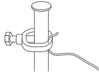
3. Conecta la varilla y el cable de tierra física con la abrazadera incluida.
