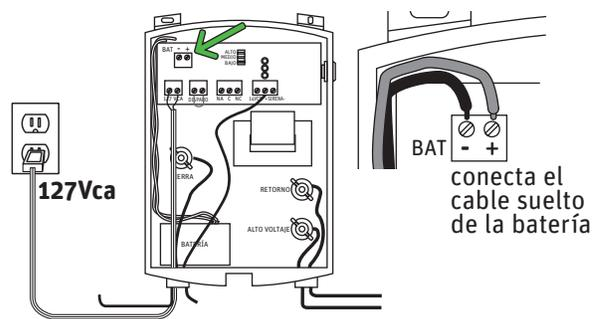
10. Alimenta con el cable de alimentación a 127Vca\*. Conecta el cable suelto de la batería.
