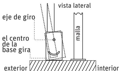
7. Si se tiene malla ciclón se deben inclinar hacia afuera los postes.
