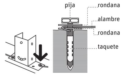
6. Con el alambre galvanizado conecta todas las bases, atornilla entre las rondanas exteriores. Esta conexión es para la tierra física, es muy importante.
