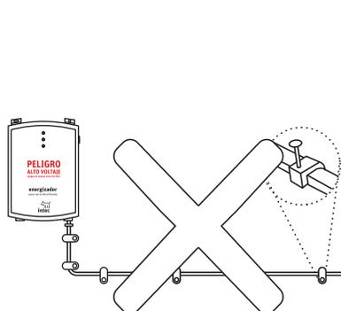
6. Preferentemente usa ductos de plástico o canaletas para llevar el cable de alto voltaje. No engrapes el cable doble aislado provoca fugas de alto voltaje y falsas alarmas.
