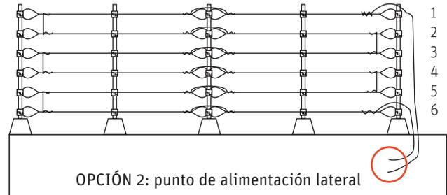
1. Es necesario dejar abierto el punto donde tendrás la entrada y salida del alto voltaje. Esto es el punto de alimentación, puede ser intermedio o lateral.
