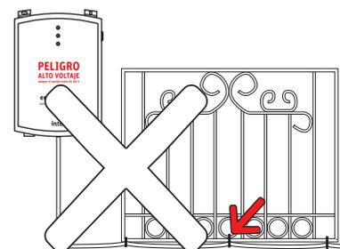
8. El cable de alto voltaje no puede ir en ductos subterráneos o en ductos compartidos con otros cables. Debe ir separado al menos 5 cm de cualquier material conductor o zonas húmedas.
