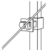
7. En los postes intermedios coloca el alambre entre los ganchos del aislador.
