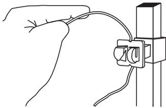
1. Con el alambre galvanizado tenderemos las líneas de alto voltaje. Pasa un extremo por el hueco del aislador más alto.
