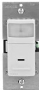
Sensor Universal 120V~ 60Hz 180° PIR Auto ON* 150W LED 600W Incand. 1P, 3 vías encendido triac no requiere tierra Cat. IPS06
