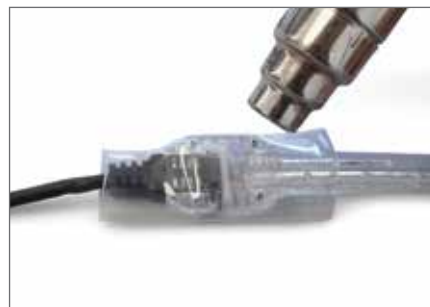
PASO 4 Deslizar el tubo termocontráctil sobre la conexión, aislar y aplicar aire caliente con termocontráctil
